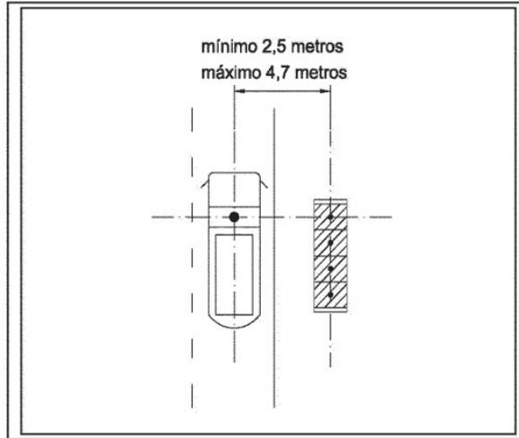
Figura 3. Distancias máximas y mínimas entre camión y contenedores
