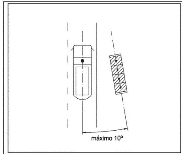
Figura 4. Ángulo máximo entre camión y contenedores
